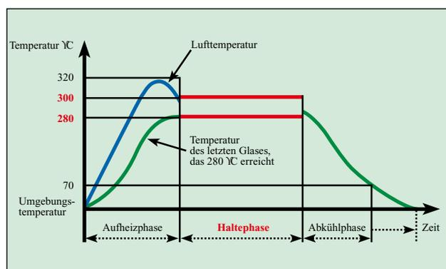
Abbildung 4 : Der Temperaturverlauf während der Heißlagerung.
