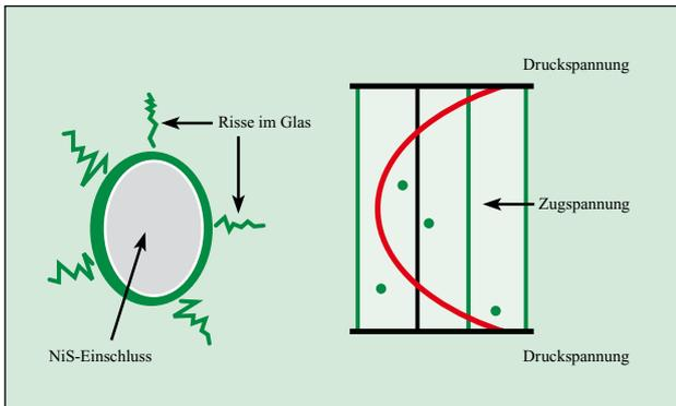
Abbildung 1: Der Bruchmechanismus eines NiS-Kristalls in der Glastafelmitte.
