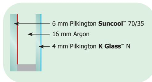
erreicht auch in Bezug auf Energieeinsparung gute Ergebnisse. Es hält die Heizwärme im Raum und lässt gleichzeitig besonders viel Sonnenenergie hinein, was zu einer Reduzierung der Heizkosten führt. Da bei diesem Glas keine Randentschichtung nötig ist, kann es sehr schnell und wirtschaftlich zu Isolierglas verarbeitet werden.
