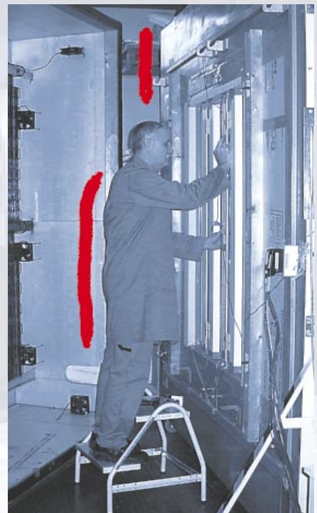
Messung des Wärmedurchgangskoeffizienten mittels Heizkastenverfahren
